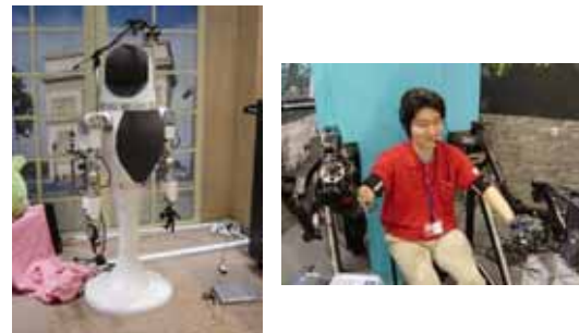
図1 相互トレイグジスタンスマスタスレーブロボット "TELESAR II" (左)スレーブロボット(右)マスタコックピット
