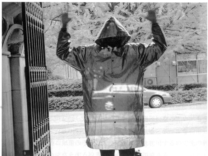
物体の後に配置したビデオカメラの映像をイメージ・ベースト・レンダリングの手法で観測者視点の映像に変換し、再帰性投影技術（RPT）を用いて投影することで、あたかも人間が透明であるかのように提示できる。
