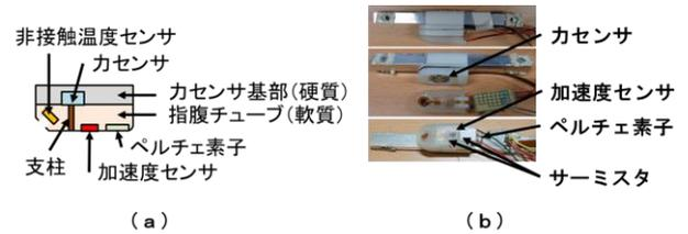
図1: 触感プローブの構成 (a) と実製作物 (b)
