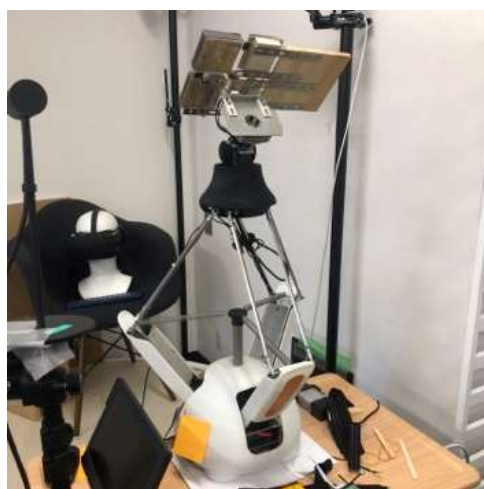
図3 遭遇型ディスプレイのための6自由度ロボット Fig.3 6DOF robot for encounter-type haptic display
